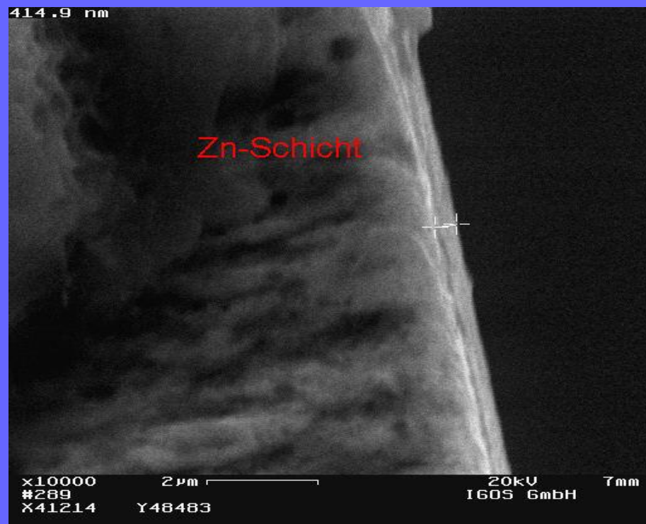
x 10.000 grubość powłoki 414 nm na cynku alkalicznym
